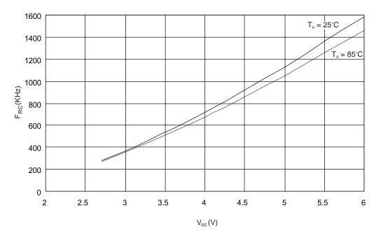
WATCHDOG OSCILLATOR FREQUENCY vs. V<sub>cc</sub>
